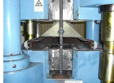
鉄筋引張試験機
