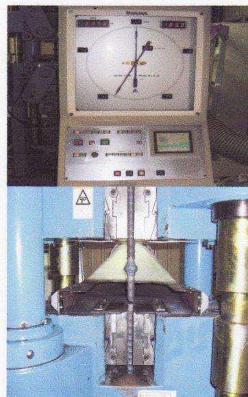
鉄筋の引張試験機
