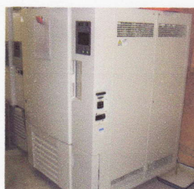
モルタルバー養生槽
